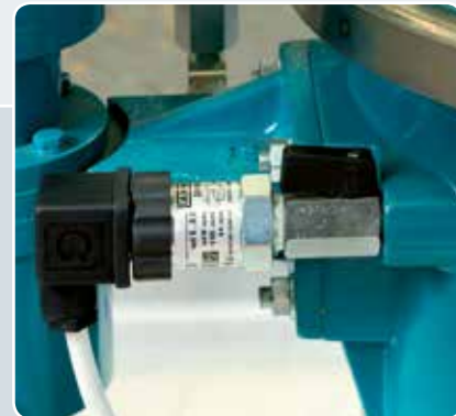
Pressostato di rilevamento intasamento Pressure switch for detecting clogging
